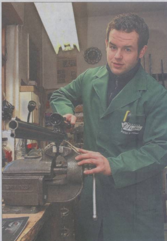
In der Werkstatt von Waffen-Seeber montiert Peter Hammer mit geübtem Griff ein Zielfernrohr auf ein Jagdgewehr. Diese Technik nennt man „Suhler-Einhakmontage“.
